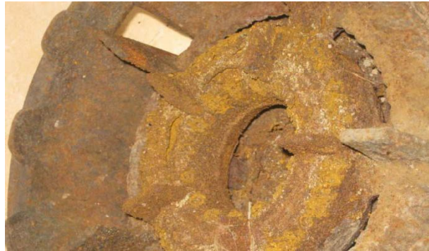
Gambar 3. Foto kerusakan akibat korosi pada burner
